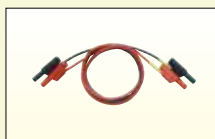
758917 测试线 每套两根。用758917连接785922或758929。 总长度: 75cm 额定: 1000V、32A
